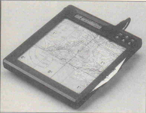
Bild 10. Die Karte ist eine 'echte' Papierkarte; das Fadenkreuz zum Anzeigen der Position wird vom LC-Display dargestellt (Teldix CoPilot).
