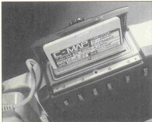
Bild 13. Nach dem Öffnen einer kleinen Klappe sind die Schächte für die Speicherkarten zugänglich (Sony).
