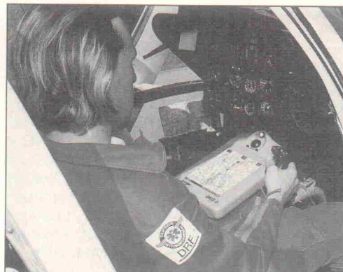
Bild 11. Beim DKG 3 besteht der Bildschirm aus einem TFT-Display; die gesamte Elektronik (außer dem GPS-Empfänger) befindet sich im Kniebrett-Gehäuse.
