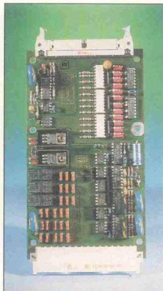
Addipos PA 820: Die externe Interfacekarte im Euro-Format sorgt für die galvanische Trennung der Ein- und Ausgangssignale.
