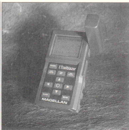
Bild 15. Magellan Trailblazer; der Finger rechts am Gehäuse ist die Antenne.
