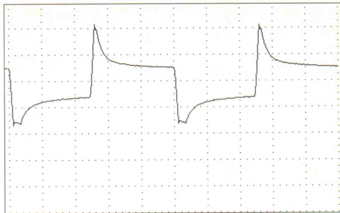
Bild 6. Oszillogramm eines Kurzschlusses am Ausgang bei Vollaussteuerung ( y = 0,5 sV/Div, x = 0,2 ms/Div).
